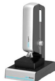
Die Messsysteme der  $\mu$ surf-Reihe sind dabei in mehreren Bauweisen lieferbar, je nach Kundenanforderung. Angefangen von Tischgeräten für den Laboreinsatz, über transportable Geräte für den Einsatz bei nicht transportablen Objekten (z.B. Karosserien), bis hin zur Integration in Fertigungsmaschinen und Analysesystemen, sind alle Varianten möglich. Der Messkopf ist sogar für den Einsatz an einem Roboterarm optimiert.
