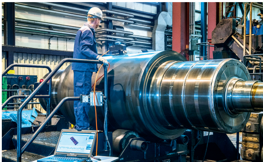
Bild 2. In der Fertigung: Messung mit mobilem optischen 3D-Oberflächenmesssystem auf einer Stützwalze (© thyssenkrupp Steel Europe AG)
